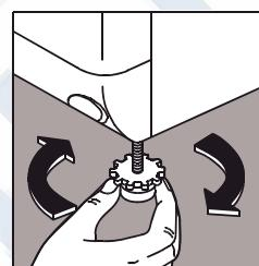
Выровняйте положение машины, регулируя слишком короткую ножку. Выкрутите вместе основание ножки и блокировочное кольцо (при необходимости поднимите стиральную машину).
